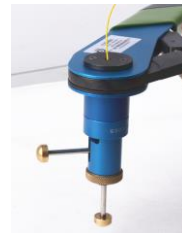
4 将定位杆缩回压接孔，放置导线，闭合把手压接
