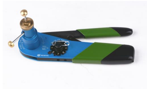
4 将定位杆缩回压接孔，放置导线，闭合把手压接
