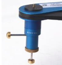
2 将定位杆伸出压接面
