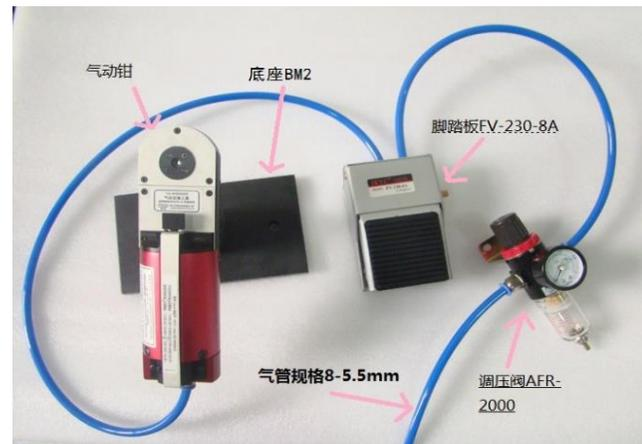
2、本工具适用M22520/7-01手动压接工具的所有定位器（需单独采购），钳体有个8档位的调节盘(正常使用第五挡)，用于调节4个压块的工作直径
