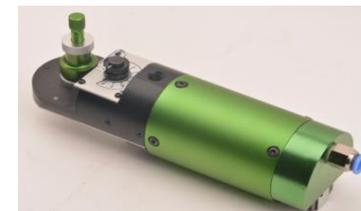
3、压接说明，放入端子和导线，用脚踏板或手动开关给钳体供气，钳体完成压接后松开脚踏板或手动开关，压块退回原位后取出压接体，压接完成。
