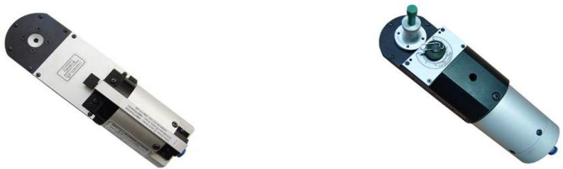
3、压接说明，放入端子和导线，用脚踏板或手动开关给钳体供气，钳体完成压接后松开脚踏板或手动开关，压块退回原位后取出压接体，压接完成。
