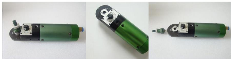
3、压接说明，放入端子和导线，用脚踏板或手动开关给钳体供气，钳体完成压接后松开脚踏板或手动开关，压块退回原位后取出压接体，压接完成。
