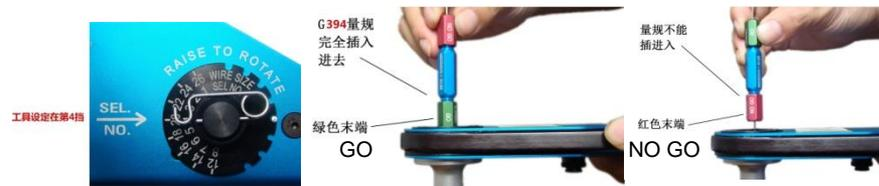
**产品警告：首先紧闭YJQ-M300压接工具，然后用通止规测试。不可压接通止规。**
